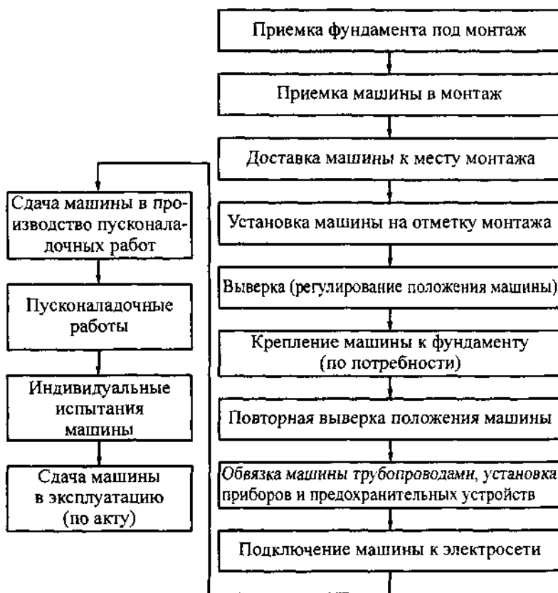
Рисунок 1.2 – Схема технологических операций, выполняемых субподрядчиками
