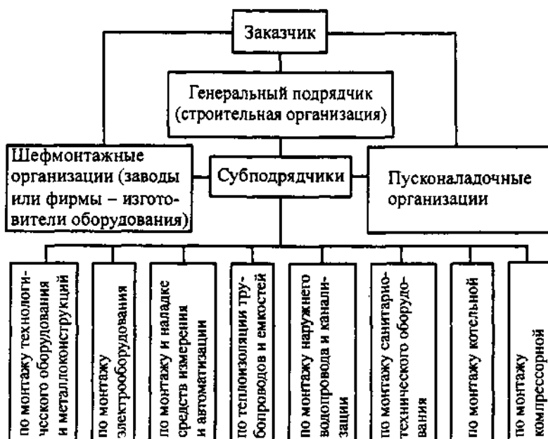
Рисунок 1.1 – Схема взаимосвязи заказчика и подрядчиков при организации строительных, монтажных и специальных работ подрядным способом
