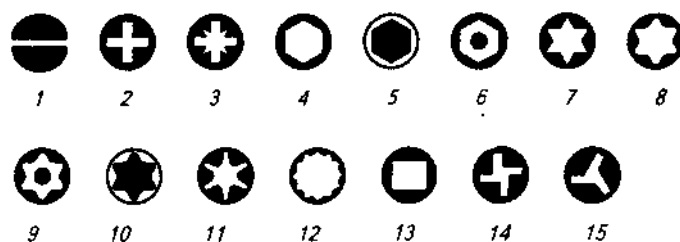
Рисунок 1.13 – Виды рабочих профилей в головках крепежа: 1 – шлиц; 2 – крест; 3 – двойной крест; 4 – внутренний шестигранник; 5 – наружный шестигранник; 6 – шестигранник с центрирующим штифтом; 7 – звезда; 8 – звезда овальная; 9 – звезда с центрирующим штифтом; 10 – звезда наружная; 11 – шлицевая звезда; 12 – многогранник внутренний; 13 – квадрат внутренний; 14 – смещенный крест; 15 – смещенный тройной шлиц
